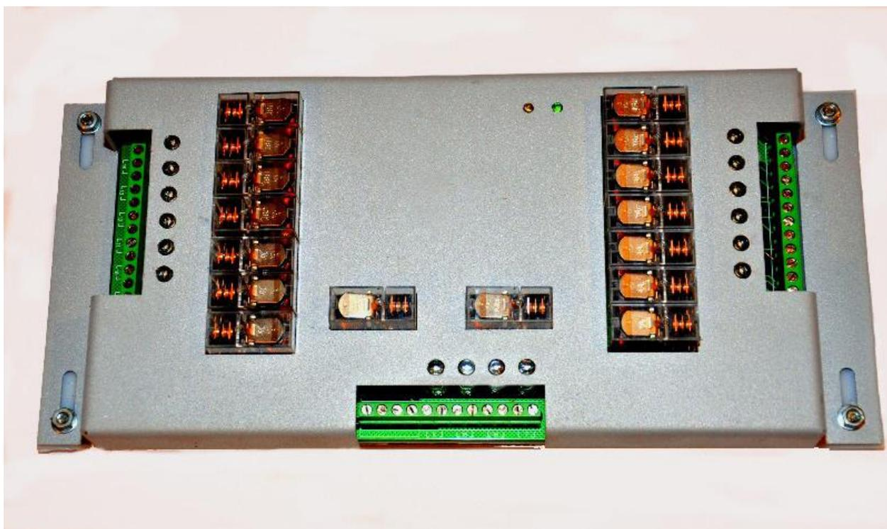
Блоки вывода сигнала – идентичны и взаимозаменяемы. Подключаются каскадом, выход одного блока является входом для следующего и т.д.
